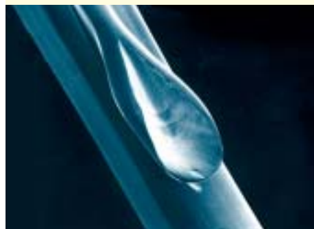
CUCHARA DE LENGÜETA DESGASTADA
