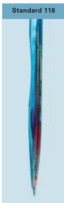
MAUVAIS ALIGNEMENT DE L'AIGUILLE DANS LE SUPPORT
