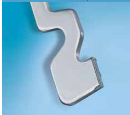
Talon d'aiguille cassé avec entaille de rupture
